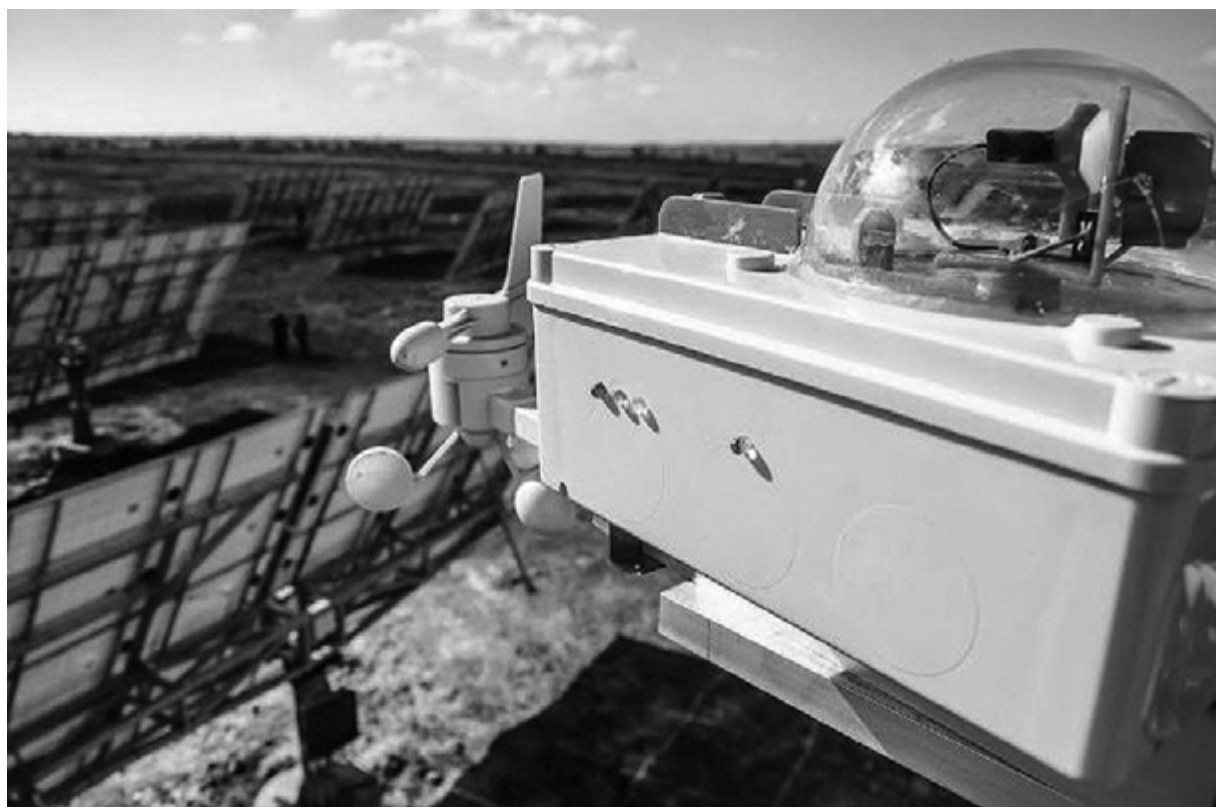
С помощью специальных датчиков батареи «следят» за солнцем
