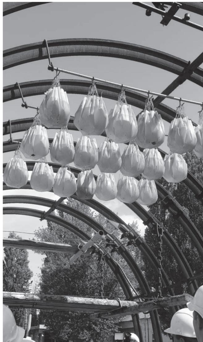
Продемонстрировал Юрий Коновалов приспособление «Катюша», которое служит для спуска в шахту стоек арочной крепи:
